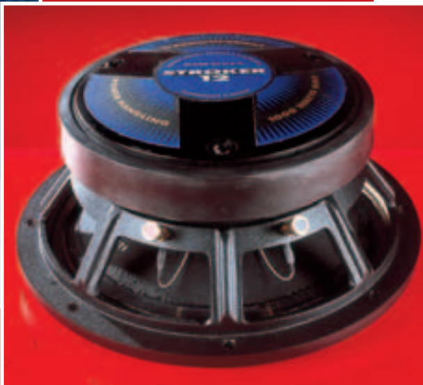
Eine Frage der Größe: Wie groß der Magnet eines Woofers ist, sagt weniger über seine Qualität aus als über seine Gehäuseeignung. Starke Antriebe brauchen oft ventilerte Gehäuse.
