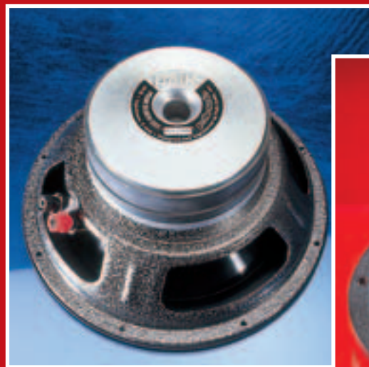
Eine Frage der Größe: Wie groß der Magnet eines Woofers ist, sagt weniger über seine Qualität aus als über seine Gehäuseeignung. Starke Antriebe brauchen oft ventilerte Gehäuse.
