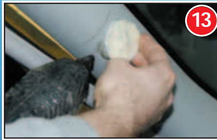
Das Einsetzen des Hochtöners in die A-Säule geht total einfach: Erst ein Loch in die ausgebaute Verkleidung fräsen und den mit Klebeband geschützten Hochtöner (so dick wie später das Kunstleder) mit Heißkleber fixieren und einspachteln.
