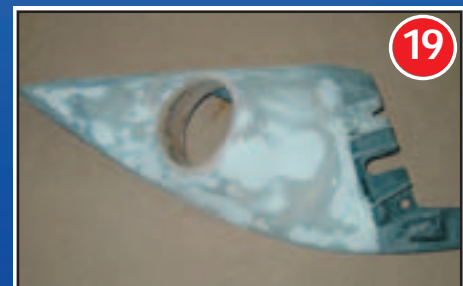
Nun heißt es, das Konstrukt mit Glasfaserspachtel in Form zu bringen. Der Spachtel lässt sich während des Härtens mit einem Messer grob schnitzen. Dann folgen die letzte Schicht Feinspachtel und abschließendes Schleifen.
