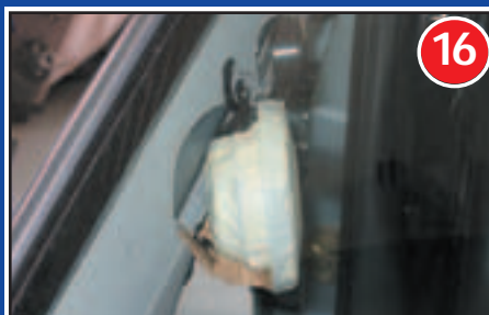
Auch die Zweifrage A-Säule bekommt wie beim Hochtöner zwei Löcher gefräst. Dann die Chassis leicht auf den Hörer ausrichten und fixieren. Nun geht's genauso weiter wie bei den Hochtönern: Spachteln, Schleifen, Beziehen, Fertig!
