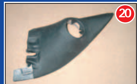
Jetzt kann das Konstrukt mit Kunstleder oder dem gewählten Bezugsstoff bezogen werden. Der Stoff bzw. das Leder wird um die Kante der Tweeteröffnung rumgelegt und innen verklebt. Der Hochtöner sollte satt in die Öffnung passen.
