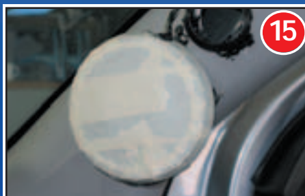
Der neueste Trend aus Asien sind Dreiwege-Systeme, bei denen der Mitteltöner ebenfalls in die A-Säule wandert. Das funktioniert am besten mit gekapselten Mitteltonkalotten, weil diese bereits ein angekoppeltes geschlossenes Volumen haben.
