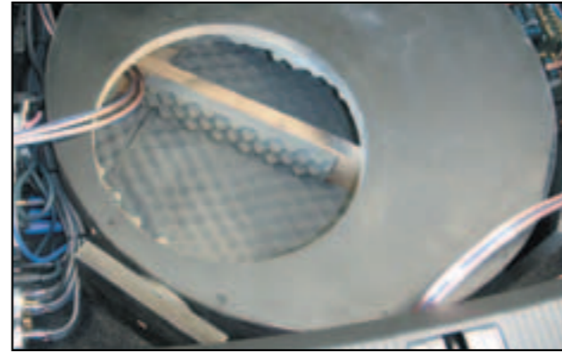
Schluckspecht: Noppenschaumstoff schluckt den rückwärtigen Schallanteil, was oft dem Bass zugute kommt.
